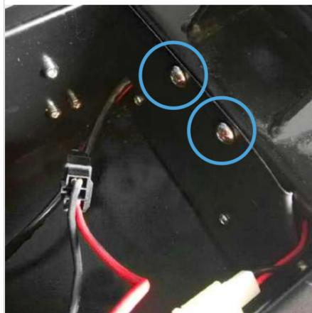
Etape 2 - Dévissez les deux vis maintenant le compartiment du calculateur en place
